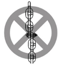
No usar pernos u otros para anudar o acortar la cadena de elevación.
