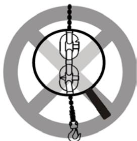
Prohibido usar el polipasto si tiene deformaciones o grietas en la cadena de elevación.
