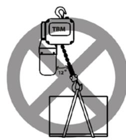
No se deben levantar cargas si la cadena se inclina más de 12° de la posición vertical.
