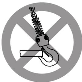
No debe soportarse la carga directamente de la punta del gancho.
