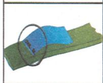
(2) Comprobar en la etiqueta de la eslinga, la carga máxima de utilización, según la posición de trabajo y longitud.
