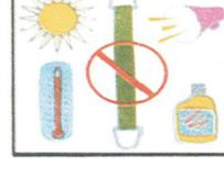
(12) No utilizar ni por encima de 100°C ni por debajo de -40°C. Ni almacenar las eslingas en el suelo, ni bajo luz directa solar, luz ultravioleta, ni fuentes intensas de calor o productos químicos
