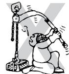
Nunca use la palanca con extensión. Usted estaría dañando el equipo si lo sobrecarga y se excede o si usted usa una extensión de la palanca para izar o tirar una carga.
