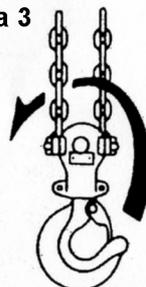
3. Examinar la cadena de carga para asegurarse de que no hay torsiones. Cuando su polipasto de palanca es de 6 toneladas que trabaja con 2 cadenas de carga, las torsiones pueden surgir fortuitamente desde el gancho inferior al girar las cadenas de carga (ver figura 3.)
