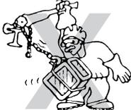
Asegúrese de que el PALFER y la carga estén en línea recta entre cada gancho. Asegúrese de que la carga esté agarrada de forma segura al gancho.
