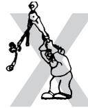
Los ganchos que estén dañados, o tengan una apertura de la garganta mayor de la normal no deben ser usados. Si el seguro no engancha en la garganta del gancho el Polipasto debe ser retirado del uso o servicio.
