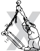
No inclinar la carga en el gancho. No cargar por encima del seguro del gancho. El seguro del gancho es para prevenir el desprendimiento de la carga en que la cadena presente flojedad.
