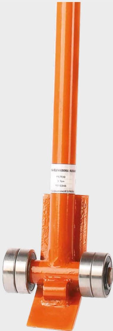
La Palanca elevadora es una herramienta ideal para elevar y así poder introducir gatos uña o tanquetas bajo las chapas o cargas a transportar o elevar.
